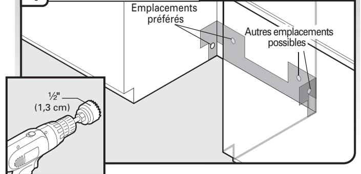
Percer un trou de  $\frac{1}{2}$ " (1,3 cm) dans le panneau latéral ou à l'arrière du placard.
